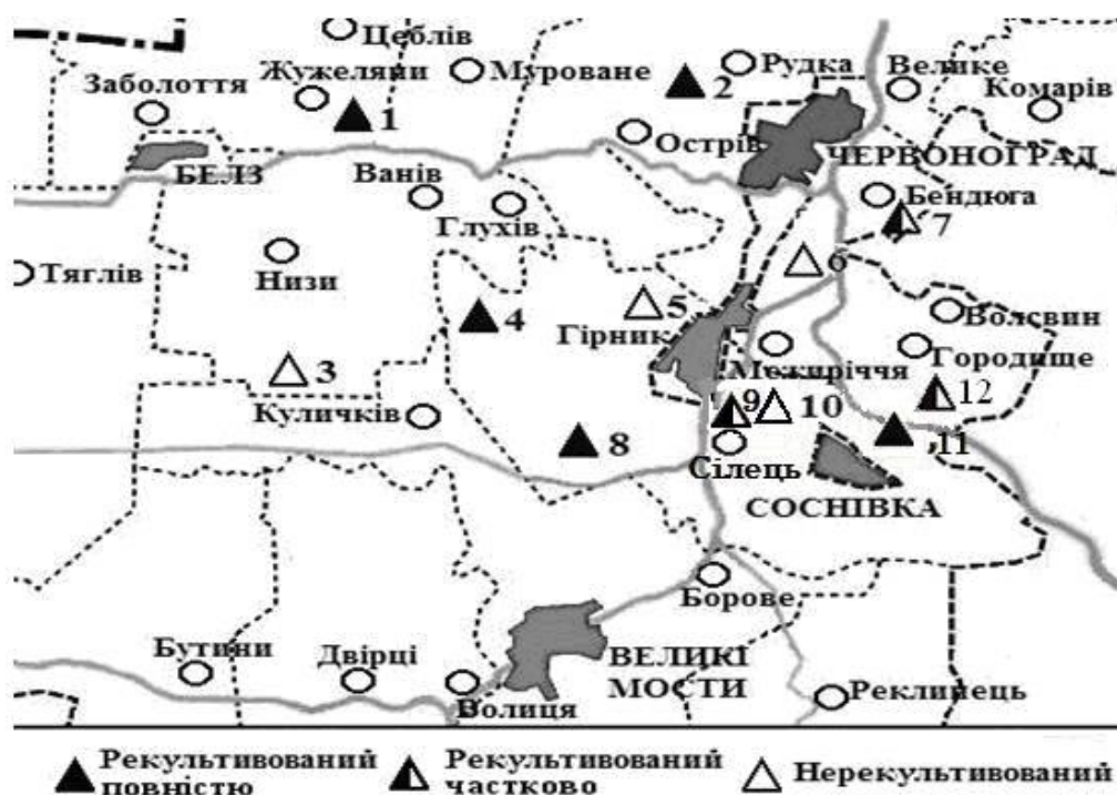
Рис. 2.5. Розташування відвалів шахт Червоноградського гірничопромислового комплексу і об'єми рекультивації на них. 1 – шахта Степова, 2 – шахта Червоноградська, 3 – шахта Лісова, 4 – шахта Відродження, 5 – шахта Великомоствська, 6 – шахта Межирічанська, 7 – шахта Бендюзька, 8 – шахта Зарічна, 9 – шахта Візейська, 10 – ЦЗФ, 11 – шахта Надія, 12 – шахта Великомоствська №5
