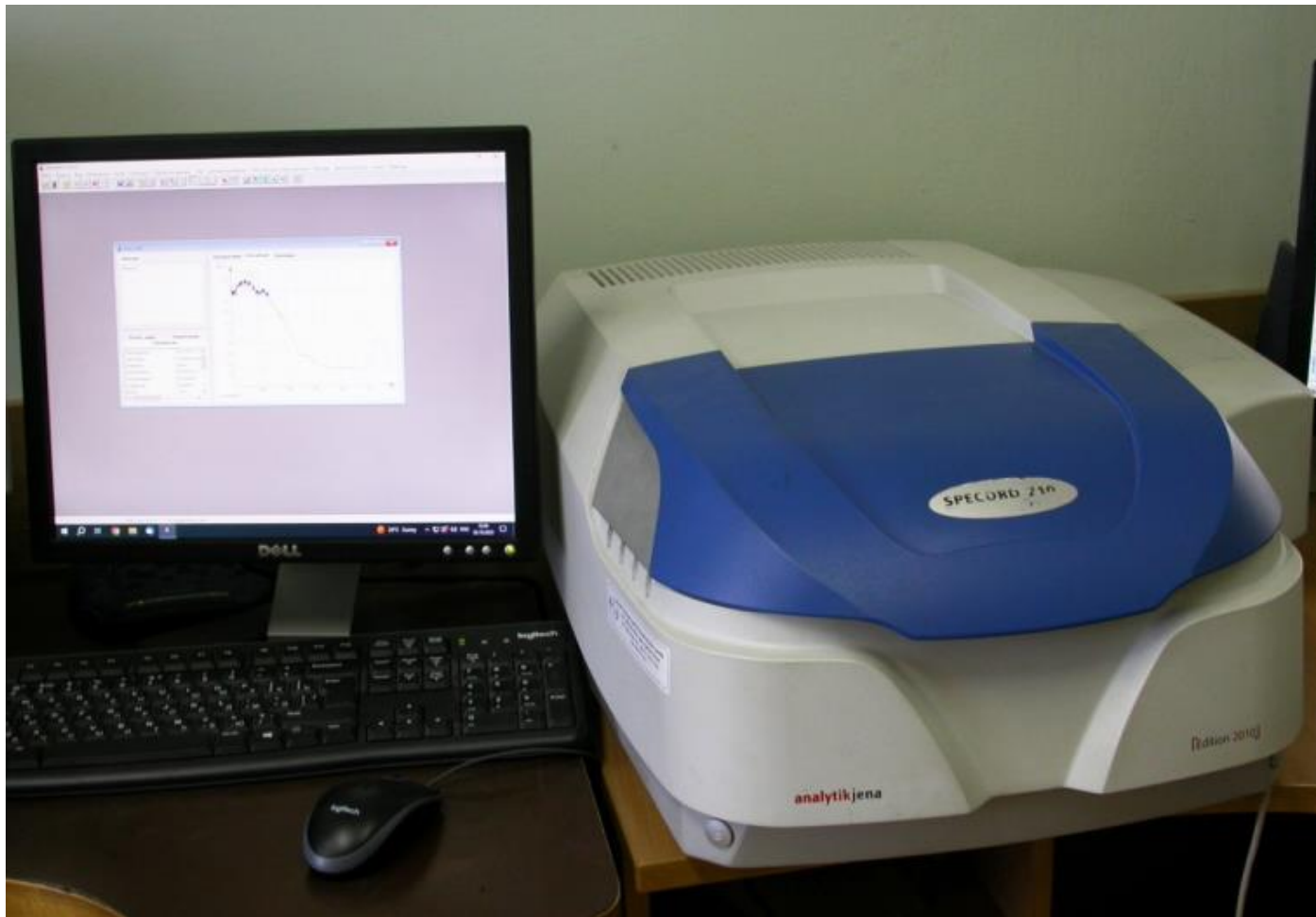
Спектрофотометр Specord 210 (Analytik Jena)
