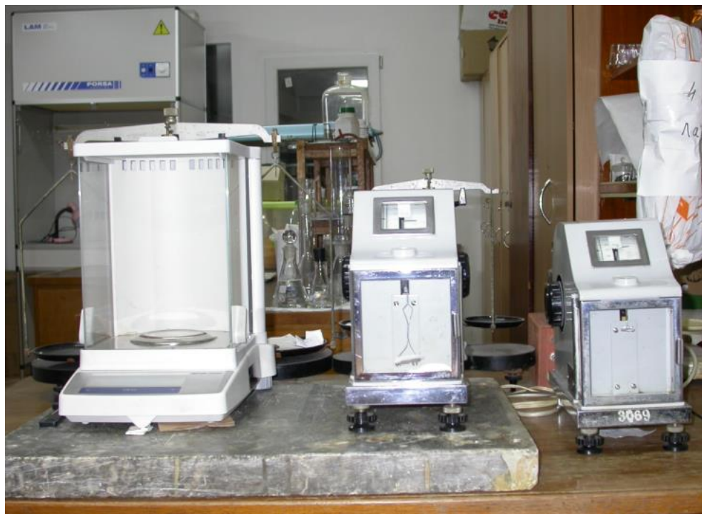
ваги електронні "Mettler Toledo" AB104-S; торсійні ваги
