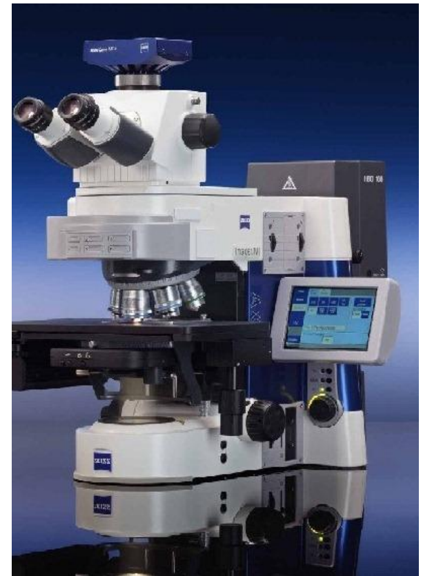
Флуоресцентний моторизований мікроскоп Axio Imager M1 (“Carl Zeiss”)
