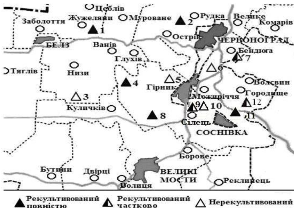
Рис. 2.6. Розташування відвалів шахт Червоноградського гірничопромислового комплексу і об'єми рекультивації на них. 1 – шахта Степова, 2 – шахта Червоноградська, 3 – шахта Лісова, 4 – шахта Відродження, 5 – шахта Великомоствська, 6 – шахта Межиричанська, 7 – шахта Бендюзька, 8 – шахта Зарічна, 9 – шахта Візейська, 10 – ЦЗФ, 11 – шахта Надія, 12 – шахта Великомоствська №5
