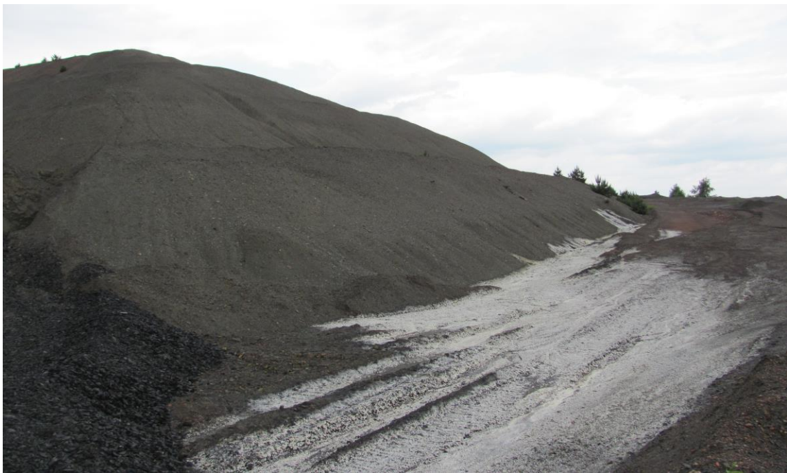
Рис. 2.10. Нагромадження солей і сірки у підніжжі відвалу Центральної збагачувальної фабрики.
