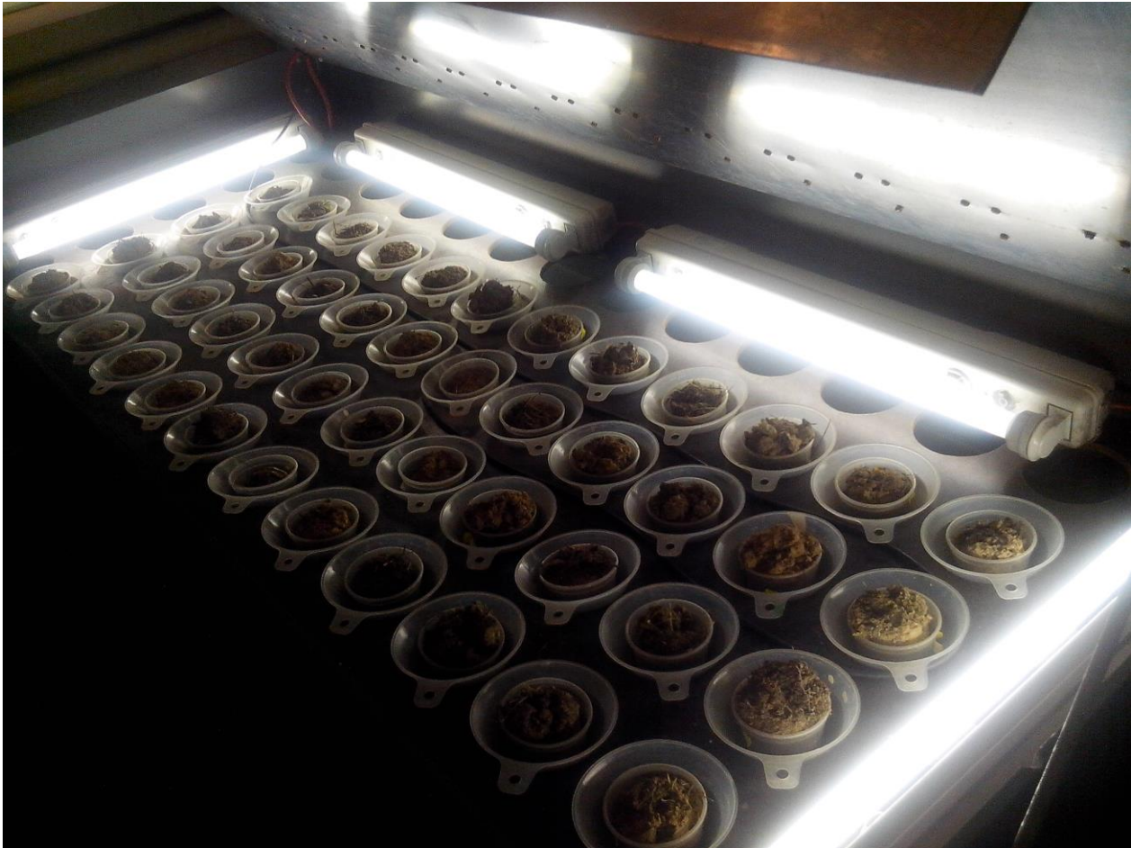
Рис. 3.2.1 Високоградієнтний еклектор Кемпсона для екстракції орібатид з ґрунту (фото автора)
