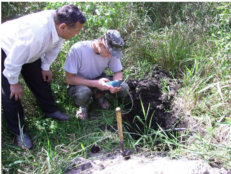
Фото 1.1. Опис ґрунту та заміри його вологості й температури приладом ТДР у заплаві р. Прип'яті
