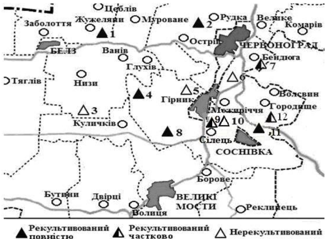
Рис. 2.1. Розташування відвалів шахт Червоноградського гірничопромислового району і об'єми рекультивації на них: 1 – шахта Степова, 2 – шахта Червоноградська, 3 – шахта Лісова, 4 – шахта Відродження, 5 – шахта Великомоствська, 6 – шахта Межирічанська, 7 – шахта Бендюзька, 8 – шахта Зарічна, 9 – шахта Візейська, 10 – ЦЗФ, 11 – шахта Надія, 12 – шахта Великомоствська № 5.
